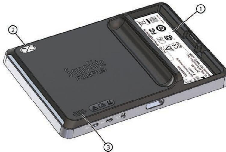
**Figura 2-2** Parte trasera del sistema de ecografía SonoSite iViz
