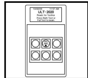
Hvis resultatet er **Mislykket**, skal du **IKKE** bruke transduseren. Ta kontakt med FUJIFILM Sonosite for reparasjon.
