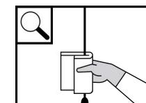
Auf eventuelle Schäden **UNTERSUCHEN**. Die Schallsonde **NICHT** verwenden, wenn eine Beschädigung festgestellt wird.
