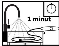
**TRIN 4 Iblødlæg** op til 90 cm af skaftet og scannerhovedet i et **godkendt** rengøringsmiddel. Sørg for, at controlleren ikke kan falde i vandet. **KONTROLLER** rengøringsmiddlets udløbsdato, og følg **ALLE** kemikalieproducentens anvisninger for blødgøringstid og temperatur.
