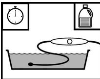
检查清洁剂的有效期，并遵循化学品制造商有关浸泡时间和温度的所有说明。
