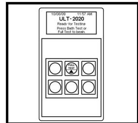
Hvis resultatet **mislykkes**, må du **IKKE** bruge transduceren. Kontakt FUJIFILM Sonosite med henblik på reparation.
