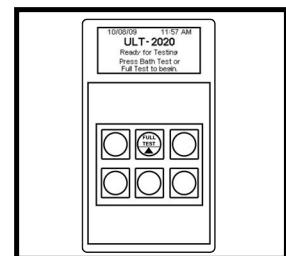
Wenn das Ergebnis **FAIL** (Nicht bestanden) lautet, darf die Schallsonde **NICHT** verwendet werden. Für Reparaturen an FUJIFILM Sonosite wenden.
