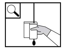
**INSPECTEER** op beschadigingen. Gebruik de transducer **NIET** indien er sporen van schade zijn.
