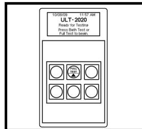
Si el resultado es **Fail** (Fallo), **NO** use el transductor. Póngase en contacto con FUJIFILM Sonosite para su reparación.
