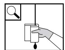
**INSPEKTERA** för tecken på skada. Använd **INTE** transduktorn om det finns tecken på skada.
