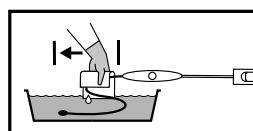
**TRIN 6 Skyl** skaftet og scannerhovedet med rindende vand ved stuetemperatur i **3 minutter**. Du må **IKKE** skylle kablet eller stikket. **INSPLICER** for resterende biologisk materiale. Gentag rengøringen, hvis der er noget til stede.
