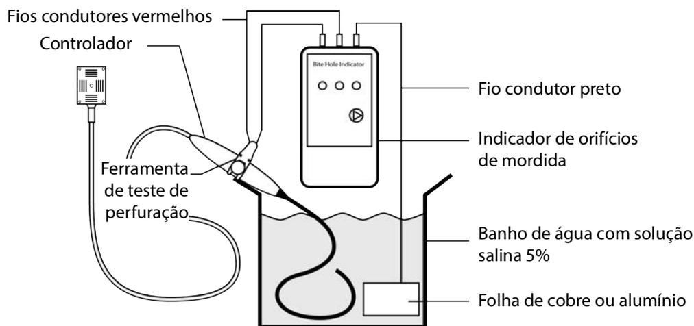
**Figura 18** Configuração de teste do eixo endoscópico
