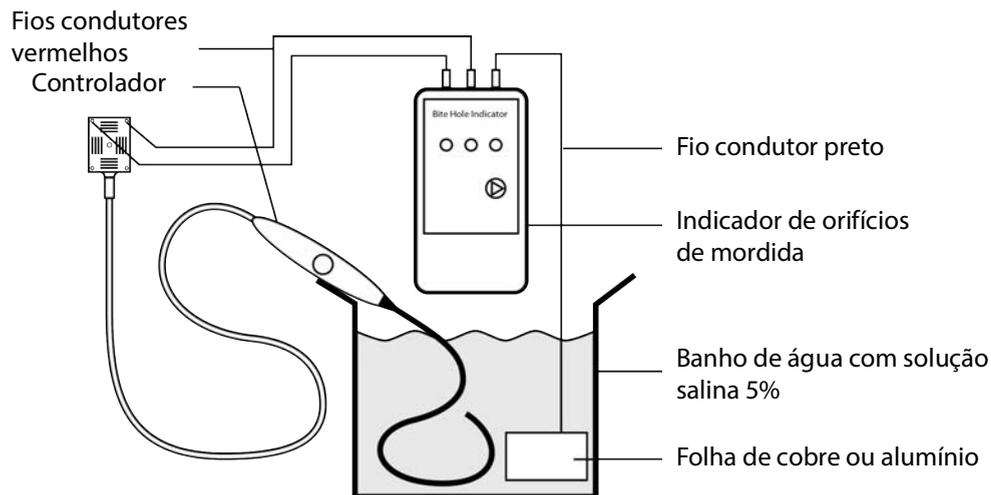
**Figura 15** Configuração de teste da matriz do transdutor
