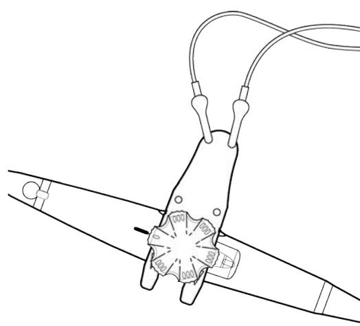
**Figura 21** Ligação da ferramenta de teste de perfuração
