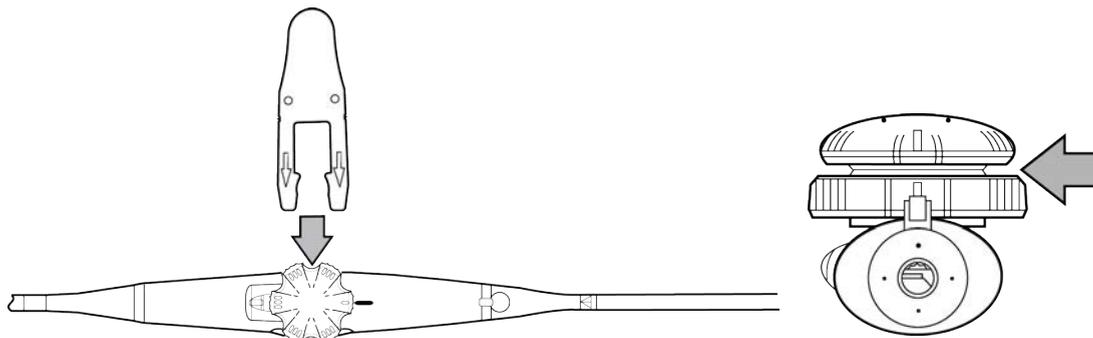
**Figura 19** Inserção da ferramenta de teste de perfuração
