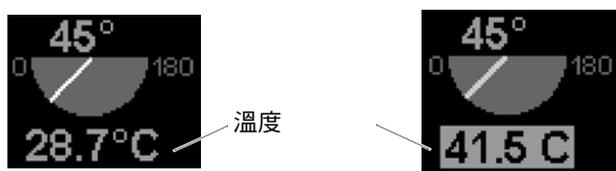
圖 11 螢幕上的轉換器端頭溫度：在限值內（左圖）與超出限值（右圖）
