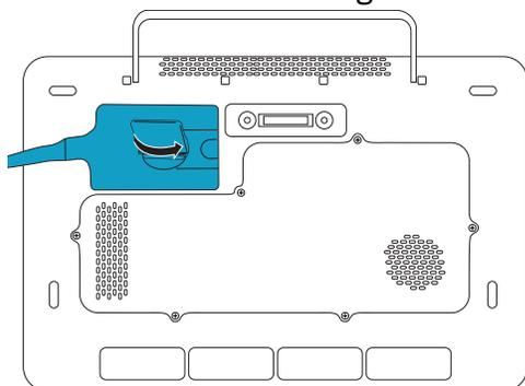
5. Abaissez le verrou pour bien fixer le connecteur de la sonde sur l'échographe.
