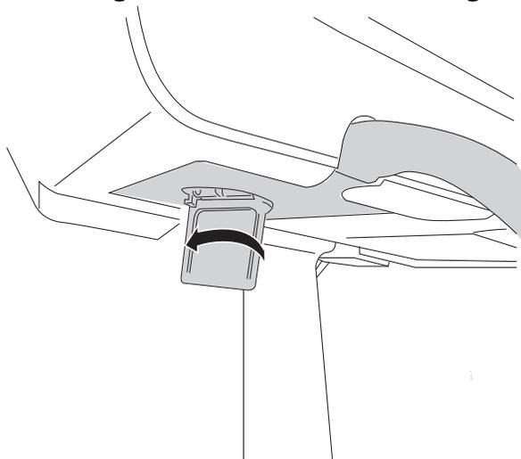
4. Levez la poignée de verrouillage pour bien fixer le connecteur de la sonde au module.
