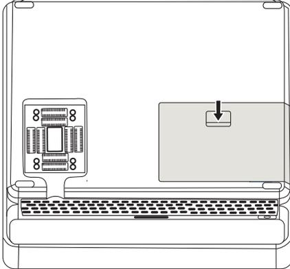
6. Inserte las tres pestañas de la caja de la batería en las tres ranuras asegurándose de que el conector de la batería esté insertado en el acoplamiento correspondiente.
