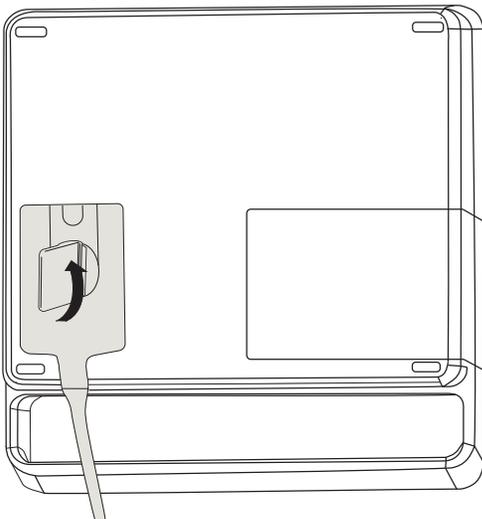
5. Presione la palanca para asegurar el conector del transductor al sistema.
