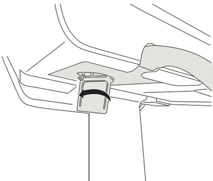
4. Presione la palanca para asegurar el conector del transductor al módulo transductor.
