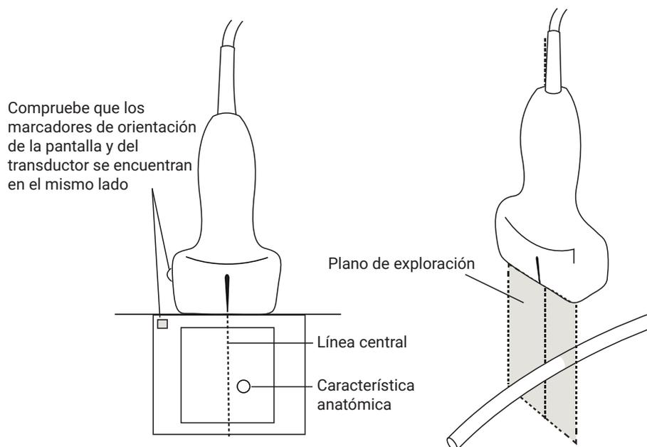
Las pequeñas inclinaciones o rotaciones del transductor pueden afectar a la relación entre cualquier punto de referencia externa y la anatomía que aparece en la imagen ecográfica.
