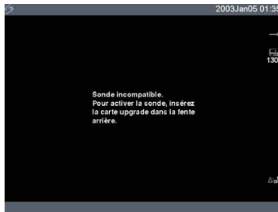
Figure 7 Mise à niveau capteur incompatible
