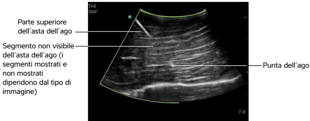
Figura 4-2 Con un trasduttore curvo, possono comparire solo segmenti dell'asta dell'ago
