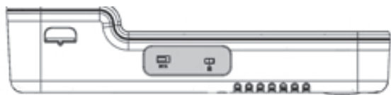
Figura 4 Lato sinistro del motore a ultrasuoni: porta ECG e slot di sicurezza Kensington (ombreggiate)
