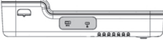
Şekil 4 Ultrason motorunun sol tarafı: EKG bağlantı noktası ve Kensington güvenlik yuvası (koyu)
