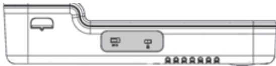
Εικόνα 4 Αριστερή πλευρά του μηχανήματος υπερήχων: Θύρα ΗΚΓ και υποδοχή ασφαλείας Kensington (με σκίαση)
