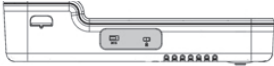
Рис. 4 Левая сторона ультразвукового генератора: порт ЭКГ и слот безопасности Kensington (затененные)
