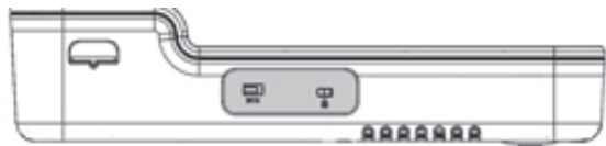
圖 4 超音波引擎左側：ECG 連接埠和 Kensington 安全插槽（陰影部分）
