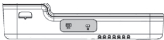
Figure 4 Côté gauche du moteur échographique : port ECG et fente de sécurité Kensington (grisés)
