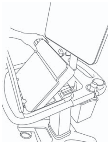
Afbeelding 6 De motor in de standaard plaatsen
