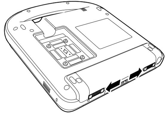
Abbildung 3 Einsetzen der Batterie
