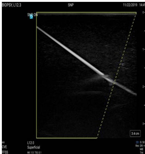
Abbildung 6-3 Bild mit eingeschaltetem Needle Profiling. Der Bereich innerhalb des grünen Trapezes umreißt den verbesserten Bereich.
