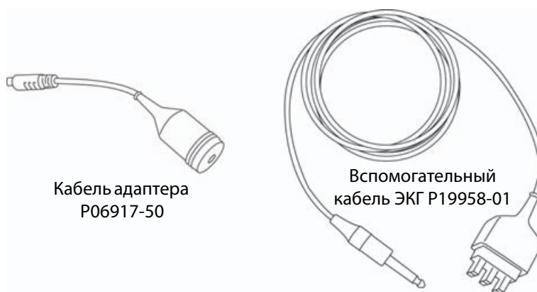
Рисунок 2-1 Компоненты вспомогательного кабеля ЭКГ и номера по каталогу
