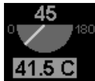
Abbildung 1 Temperatur am distalen Ende des Schallkopfs auf der Systemanzeige
